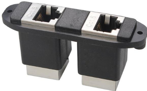
网络直通头运用磷青铜镀金金针和磷青铜镀锌卡线端子，能够起到防止表面氧化，提高接触性能的作用，从而使性能和使用寿命得到保证；采用阻燃聚碳酸脂材料，阻燃性能达到很不错的级别；采用扣锁式端接帽保护接触点，可以避免线缆端接后的过度弯曲、脱落；外形紧凑，模块上标注有通用的线序标签，便于快速准确地完成端接；带颜色的组件便于识别和容易进行网络管理。外包装一般都用质地较厚且韧性好的塑料纸密封，所以包装好网络模块的大部分质量不会差。
